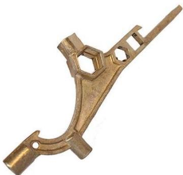
Une clé **polycoise** (norme AFNOR NF S 61-580) est un ensemble de clés présentes sur un même outil que chaque pompier a en dotation. Deux de ces clés (**triangles femelle 12 et femelle 15**) permettent, entre autres, de déverrouiller les barrières des voies pompiers.
