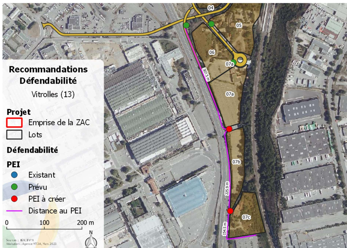
Figure 66 : recommandation d'implantation de PEI
